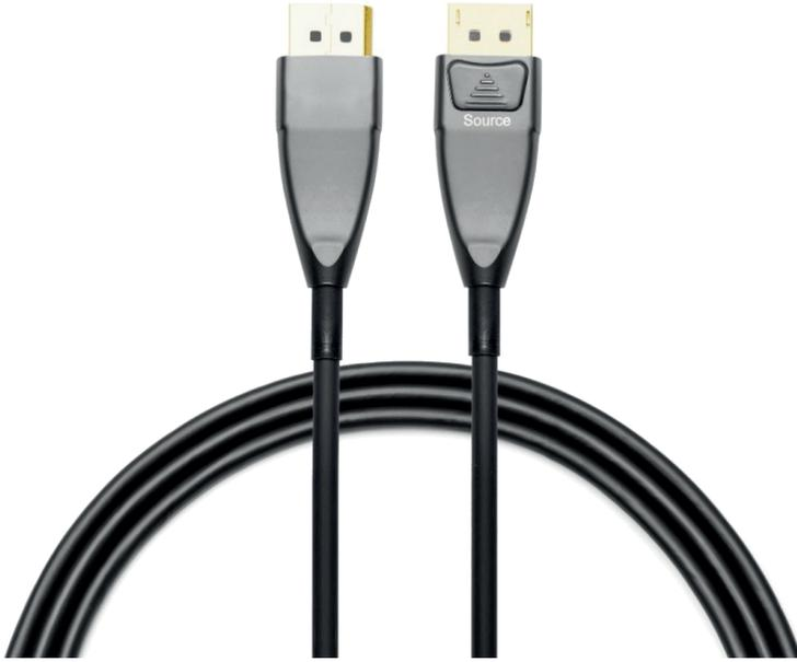
Die ab Werk konfektionierten aktiven 8K60 DisplayPort Glasfaserkabel aus der „UTE DP 1.4 Hybrid Active Optical Fiber Cable Series“ übertragen digitale DisplayPort 1.4 Signale (Audio & Video) über Entfernungen von bis zu 30 Meter und unterstützen Auflösungen bis 8Kx4K @60Hz (8K @60Hz: 7.680x4.320 Pixel mit 60 Hz) - mit 4:4:4 Chroma Subsampling (YUV 4:4:4) sowie 4Kx2K @120Hz (4K @120Hz).
