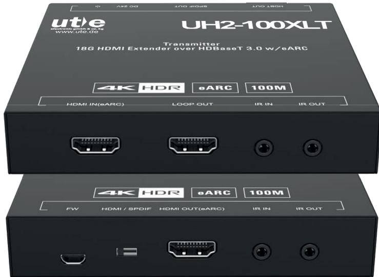
Bei dem UH2-100XL handelt es sich um eine HDMI2.0 HDBT3.0 eARC Verlängerung, die aus einem **4K60 HDBT3.0-Sender** sowie einem **4K60 HDBT3.0-Empfänger** besteht und 4K @60Hz (4:4:4) **18G HDMI-Signale kompressionsfrei** - via CAT-Kabel - über Entfernungen bis zu **100m** übertragen kann. Zudem unterstützt der UH2-100XL eARC (Enhanced Audio Return Channel) sowie die bidirektionale IR-Pass-Through-Steuerung.
