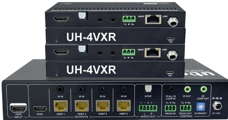
Bei dem UH-4VX SET handelt es sich um ein 4K 18 Gbit/s HDMI HDBaseT Splitter/ Extender Set, dass aus einem 1x4 4K 18G HDMI HDBaseT Splitter/ Transmitter (UH-4VX) und vier 4K 18 Gbps HDMI HDBaseT Receivern besteht.
