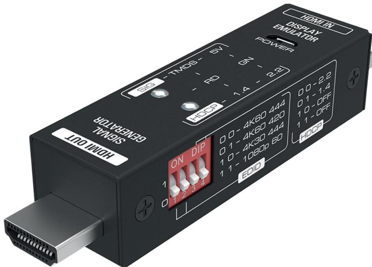
Der HDMI GEN-1 ist ein tragbarer HDMI-Signalgenerator und Bildschirm-Emulator (Signalanalysator), der zwei Funktionen (Generieren von HDMI-Signalen und Emulieren von HDMI-Bildschirmen) in einem kompakten Gehäuse vereint.
