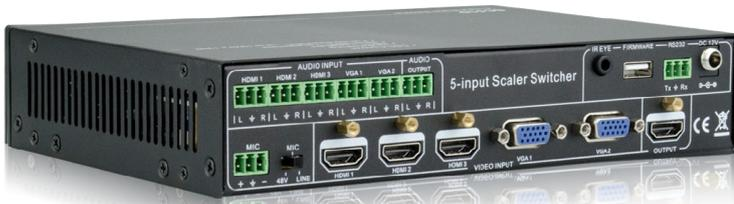
Bei dem HD-51D handelt es sich um einen kompakten Full HD Scaler mit Switching-Funktion. Er verfügt über 5 Audio sowie 5 Videoeingänge und switcht und scalet jedes eingehende Videosignal in 1080p zum HDMI-Ausgangs-Port und ist über die Funktionstasten an der Gerätevorderseite, per IR-Fernbedienung und RS232 steuerbar.
