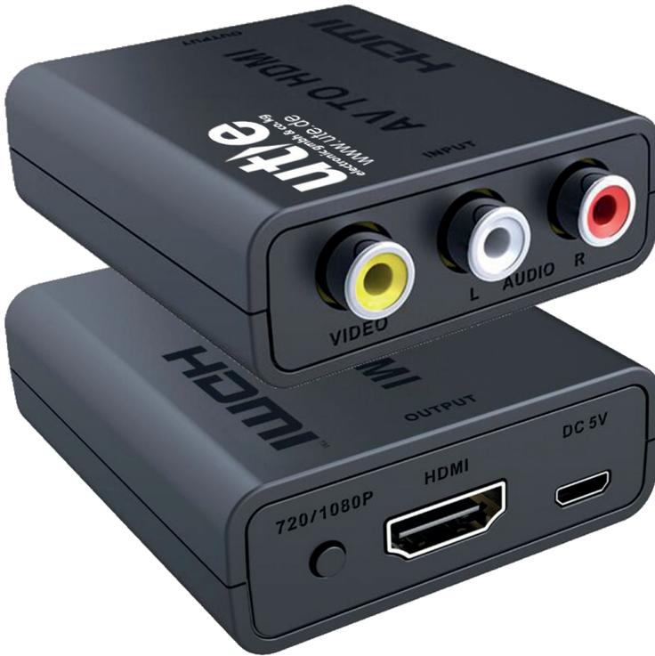
Der kompakte und zugleich leistungsstarke Composite Video und Stereo Audio auf HDMI Konverter HD-3065 ermöglicht den Anschluss von Geräten mit Cinch (Composite) Anschlüssen an moderne Bildschirme, Displays oder Beamer mit HDMI Port. Das Videosignal wird zusammen mit dem Stereo-Audio Ton digitalisiert, in ein hochauflösendes HDMI-Signal umgewandelt und über den HDMI Port ausgegeben, so dass es bspw. an HDTVs angezeigt werden kann.
