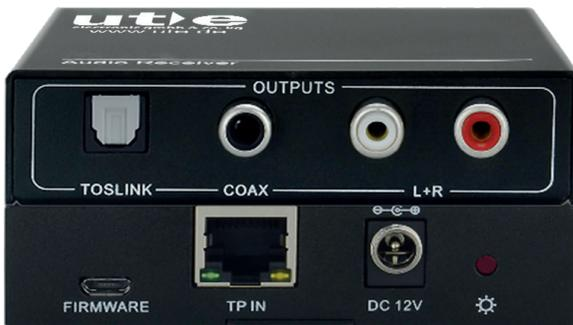
Das Audio-Extender-Set AU-290X besteht aus einem Audio-via-CAT Sender und einem Audio-via-CAT Empfänger und überträgt & verlängert analoge und digitale Audiosignale.
